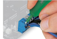
Rimozione di un conduttore rigido.
