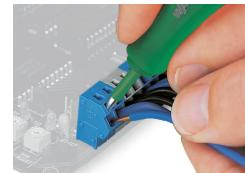
Rimozione di un conduttore rigido.
