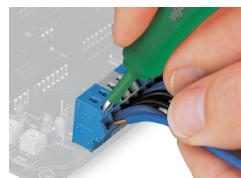
Rimozione di un conduttore rigido.
