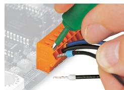
Inserimento/rimozione del conduttore con boccolla.
