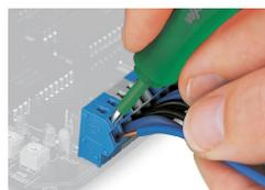
Rimozione di un conduttore rigido.
