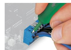
Rimozione di un conduttore rigido.
