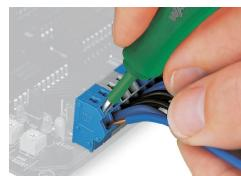
Rimozione di un conduttore rigido.
