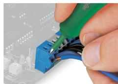
Rimozione di un conduttore rigido.
