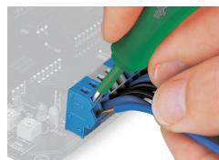
Rimozione di un conduttore rigido.
