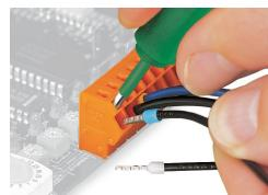
Inserimento/rimozione del conduttore con boccolla.
