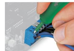
Rimozione di un conduttore rigido.
