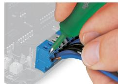
Rimozione di un conduttore rigido.
