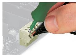
Inserimento di un conduttore a punta saldata tramite cacciavite.
