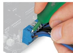
Rimozione di un conduttore rigido.
