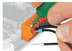
Inserimento/rimozione del conduttore con boccolla.
