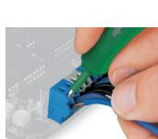
Rimozione di un conduttore rigido.
