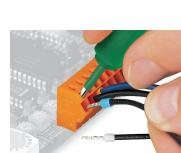
Inserimento/rimozione del conduttore con boccola.
