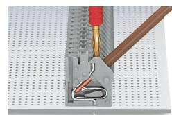
Test con spina di test di Ø 2 mm, contatto diretto, serie 250: passo tra i pin di 5 mm.
