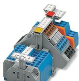
Questo sistema è utilizzabile come un portaetichette di gruppo aggiuntivo o un supporto per strisce di marcatura continuo per morsettiere o morsetti per montaggio su guida a un piano, p. es. per: morsettiere per montaggio su guida DIN 35 (serie 264) Morsetti per montaggio su guida a un piano (serie da 279 a 284) con un'altezza massima di 49 mm (1,93 pollici) dal bordo superiore della guida DIN (osservare il raggio del conduttore)
