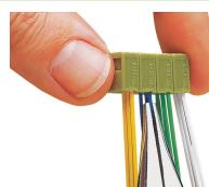
Rimozione di un conduttore con le pinze: torcere alternando tra destra e sinistra - serie 243
