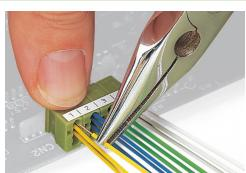
Inserimento di un conduttore usando le pinze fino a che tocca il fondo: direttamente sul circuito stampato o cablaggio precedente al montaggio sul circuito stampato.
