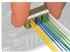
Rimozione di una morsettiera per circuito stampato per sostituire la scheda.
