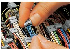
Connessione: inserire il conduttore rigido spelato fino alla battuta d'arresto.
