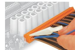
Se confrontati ai cacciavite standard questi utensili operativi sono molto più convenienti per il cablaggio delle morsettiera per circuito stampato in stabilimento.
