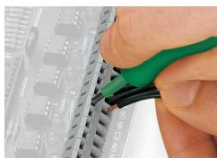
Inserimento di un conduttore tramite cacciavite di 3,5 mm.
