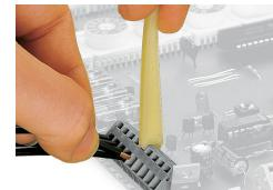
Inserimento di un conduttore mediante
