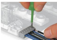
Rimozione di un conduttore tramite cac-
