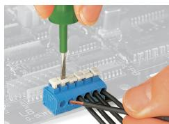
Inserimento/rimozione dei conduttori flessibili mediante pulsante.
