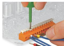
Inserire/rimuovere i conduttori flessibili con boccola tramite il pulsante.
