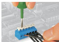
Inserimento/rimozione dei conduttori flessibili mediante pulsante.
