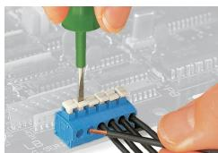
Inserimento/rimozione dei conduttori flessibili mediante pulsante.
