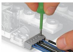
Rimozione di un conduttore tramite cac-
