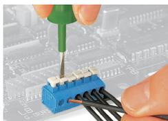
Inserimento/rimozione dei conduttori flessibili mediante pulsante.
