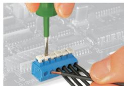
Inserimento/rimozione dei conduttori flessibili mediante pulsante.
