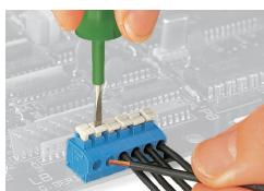
Inserimento/rimozione dei conduttori flessibili mediante pulsante.
