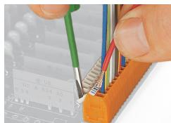
Inserimento/rimozione di un conduttore.
