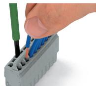
Attenzione: i ponticelli a barre a pettine riducono la sezione del conduttore a 1,5 mm<sup>2</sup> "f" + "f".
