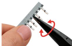
Le barre di ponticelli a pettine personalizzate sono create rompendo i contatti del ponticello (3 o più contatti).
