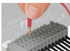
Test: connettore femmina con CAGE CLAMP®
