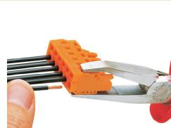
Inserimento di un conduttore mediante utensile di montaggio.
