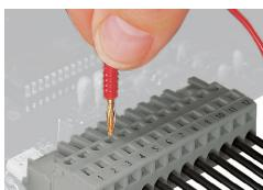
Test: connettore femmina con CAGE CLAMP®
