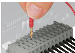
Test: connettore femmina con CAGE CLAMP®
