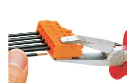
Inserimento di un conduttore mediante utensile di montaggio.
