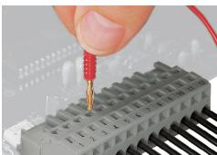
Test: connettore femmina con CAGE CLAMP®
