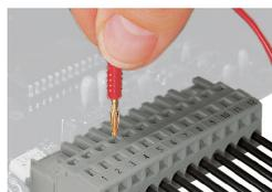
Test: connettore femmina con CAGE CLAMP®
