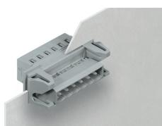
Connettore maschio con flange a scatto, per applicazioni passaparete del con spessore della piastra da 0,5 a 2,5 mm
