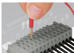
Test: connettore femmina con CAGE CLAMP®
