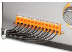
Connettori femmina per circuito stampato con flange di montaggio utilizzabili come connettori passaparete per cablaggio esterno.
