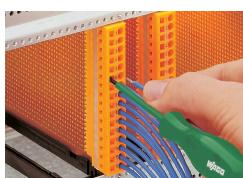
Connettore femmina a 16 poli con flange di montaggio in un rack da 19": connessione del conduttore in parallelo all'azionamento CAGE CLAMP®
