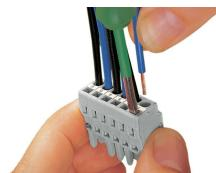
Inserimento del conduttore mediante cacciavite da 3,5 mm: azionamento di CAGE CLAMP® parallellamente rispetto all'ingresso del conduttore.
