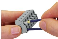
I conduttori rigidi  $\geq 0,5 \text{ mm}^2$  (20 AWG) e i conduttori flessibili con boccola crimpata possono venire connessi premendoli direttamente nell'unità. Delle aperture per test integrate consentono un contatto diretto con la barra di corrente tramite punte di prova sia in direzione orizzontale che verticale.
