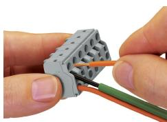
L'azionamento del Push-in CAGE CLAMP® è semplice, veloce e identico a quello del CAGE CLAMP®. Il cacciavite viene inserito completamente nell'apertura di azionamento tenendo il Push-in CAGE CLAMP® aperto. Dopo aver inserito il conduttore nell'unità di connessione e aver ritirato il cacciavite il conduttore risulta saldamente bloccato. I conduttori rigidi e flessibili < 0,5 mm<sup>2</sup> (20 AWG) vengono connessi e rimossi usando un cacciavite.
