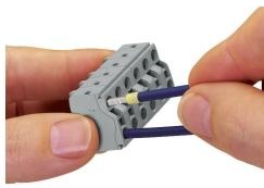
I conduttori rigidi  $\geq 0,5$  mm<sup>2</sup> (20 AWG) e i conduttori flessibili con boccola crimpata possono venire connessi premendoli direttamente nell'unità. Delle aperture per test integrate consentono un contatto diretto con la barra di corrente tramite punte di prova sia in direzione orizzontale che verticale.
