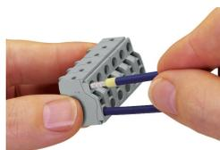
I conduttori rigidi ≥ 0,5 mm<sup>2</sup> (20 AWG) e i conduttori flessibili con boccola crimpata possono venire connessi premendoli direttamente nell'unità. Delle aperture per test integrate consentono un contatto diretto con la barra di corrente tramite punte di prova sia in direzione orizzontale che verticale.
