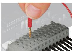
Test: connettore femmina con CAGE CLAMP®
