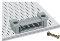
I dispositivi di bloccaggio migliorano l'affidabilità delle connessioni tra le testate del connettore maschio con pin a saldare angolati e il circuito stampato. Questo riduce nettamente la sollecitazione meccanica sia sui pin a saldare che sui giunti, in particolare quando si tratta di brevi lunghezze e frequenti cicli di accoppiamento.
