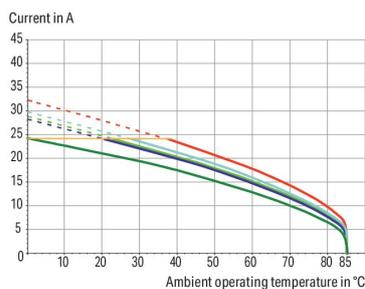
2-, 4-, 6-, 12-, 24- pole      — Conductor rated current
