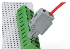
Morsettiera non cablata con modulo spina di test inserito
